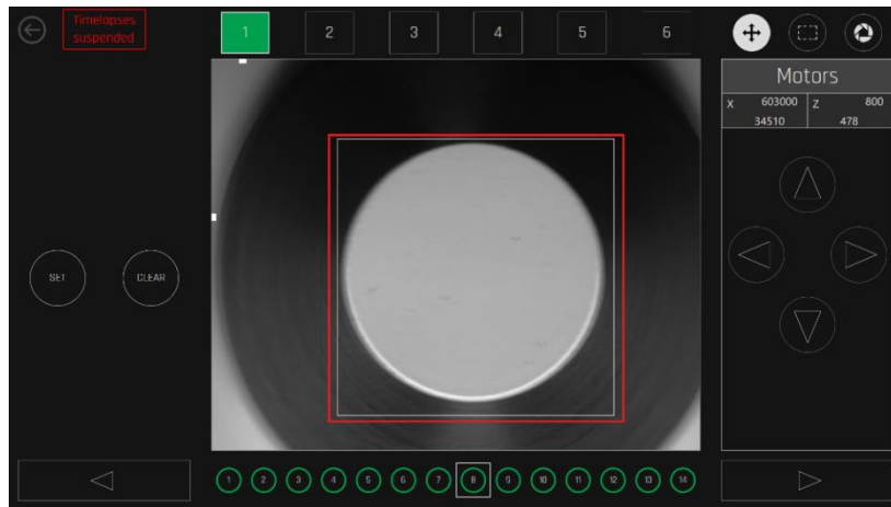
Figura 20.37 Posição do poço dentro do limite quadrado marcado
