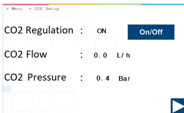
Figura 13.25 Vista do submenu de regulação CO 2 nas incubadoras FIV multicâmara MIRI® TL6 e MIRI® TL12
