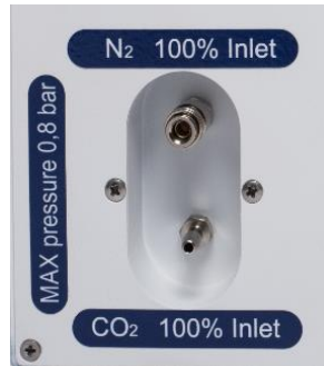
Figura 11.1 Entradas de gás
