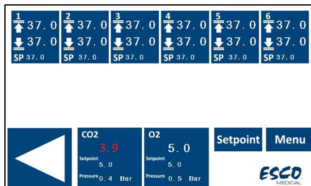
Figura 14.5 Vista do alarme de concentração baixa de CO 2 no ecrã principal da incubadora FIV multicâmara MIRI® TL6
